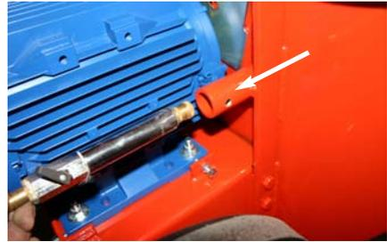
Schließen Sie einen Wasserschlauch an der Wassersprühdüse an. An der HIRLINGER-Strohhexe ist rechts unten am Gehäuse ein Rohrstück angeschweißt (s. Abb.). Dieses hat in den Innenraum des Gebläses eine kleine Öffnung. In dieses Rohr wird von unten die Wassersprühdüse bis zu Anschlag eingeschoben. Die Befestigung erfolgt durch eine Schraube M10 welche in das vorhandene Rohr eingedreht wird. Schraube nur leicht anziehen.
