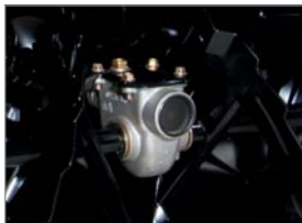
Top-Load Getriebe aus Aluminium
