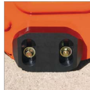
Kunststoffgleitschuhe: schonen empfindlichen Untergrund beim Arbeiten
