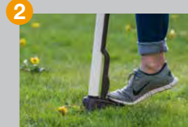
2 Das Pedal mit dem Fuß auf den Boden herunterdrücken. Den Fuß wegnehmen und den Stiel zum Pedal ziehen.
